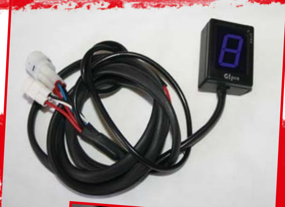
Ganganzeige und Entdrosselung in einem. Das GL-Pro. Leicht am Displaybaustein dimmbar, und wenn nötig sogar auf jedes Getriebe zu kalibrieren.
