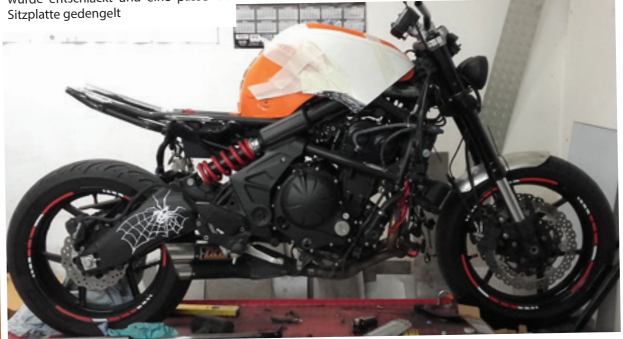
Um dem Tank etwas mehr Thüringer Charme zu verpassen, schnippelte Steffen Pappschablonen, die zudem den Wiedererkennungswert des Organs verringern sollten. Ein flacher Frontfender und eine zweiäugige Front wurden parallel angepasst. Kommt schon deutlich besser die Nummer. Findet auch Spiderman
