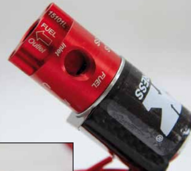
Elektrische Sperrventile regeln das Timing. Der Rote kümmert sich ums Benzin, der Blaue ist für die Gasleitung zuständig
